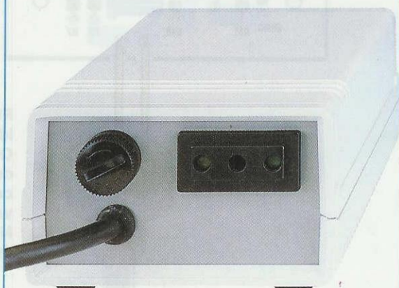
Fig.13 Il portafusibile e la presa d'uscita vanno fissati sul pannello posteriore.
