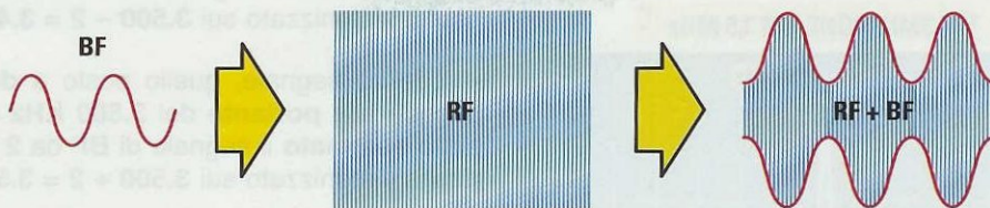
Fig.1 Per trasmettere in AM, si somma il segnale di BF alla portante RF dello stadio trasmittente e in questo modo si ottiene un segnale composto da RF+BF.
